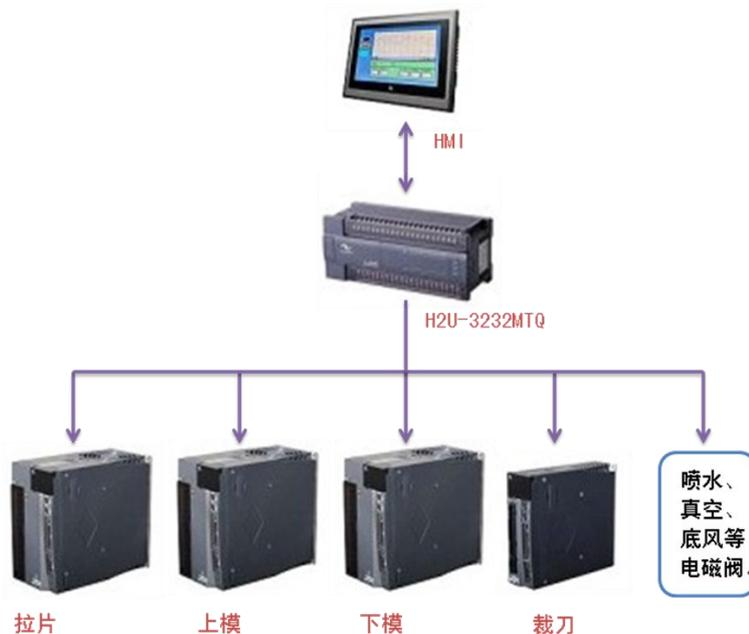
**工艺要求：**根据控制系统的工艺需求，系统需要控制四个伺服运行，其中上模伺服，下模伺服和拉片伺服运转精度要求在 0.05mm。同时 PLC 在控制电炉加热时，需要采用 PWM 的形式控制加热，便于满足在生产不同产品时的相同时间内达到不同温度控制的需求。为了方便客户生产不同产品，其生产的过程参数需要保存下来。
