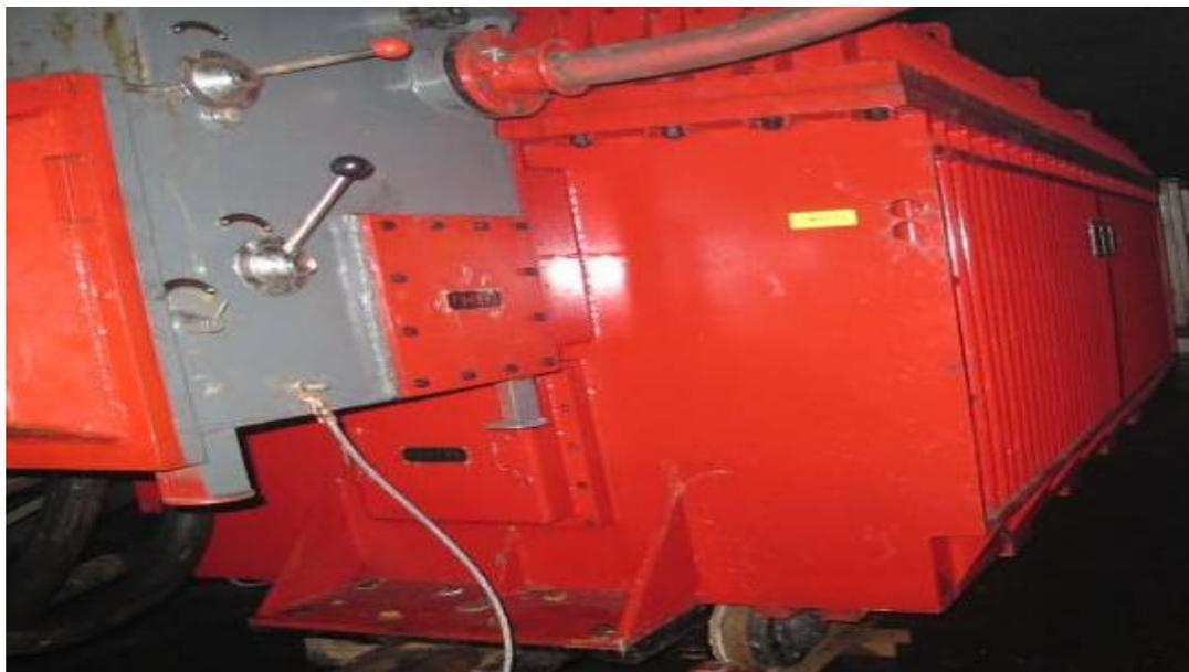
图 15 CM3000 变频器干式移相变电源图
