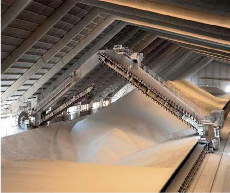
图 5 采用新驱动系统的原料场取料机
