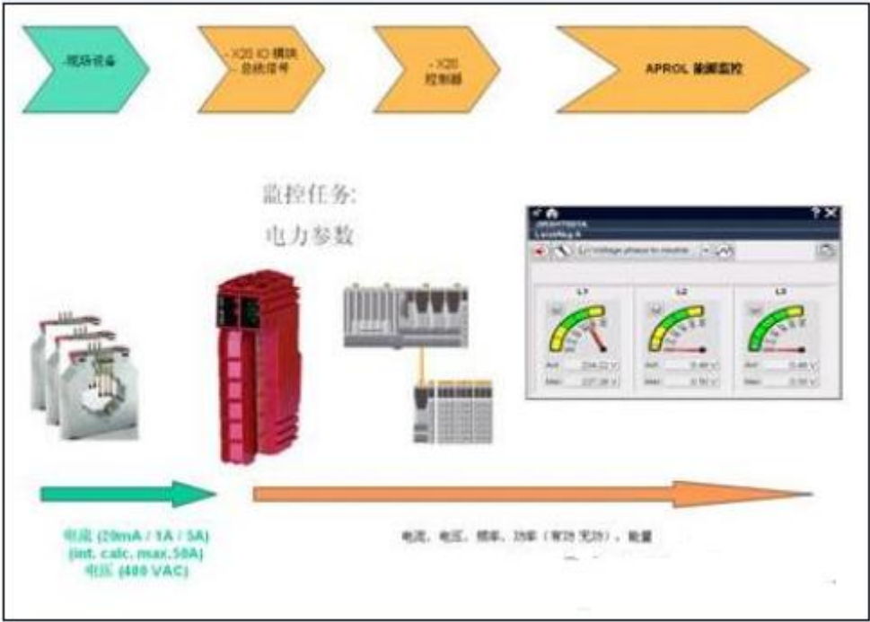
图 3 贝加莱的电能参数采集方案
