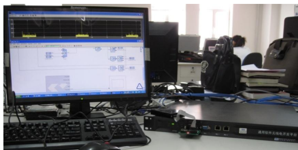
图 6 PC 机与 SDR 间 Hardware Co-simulation 实验
