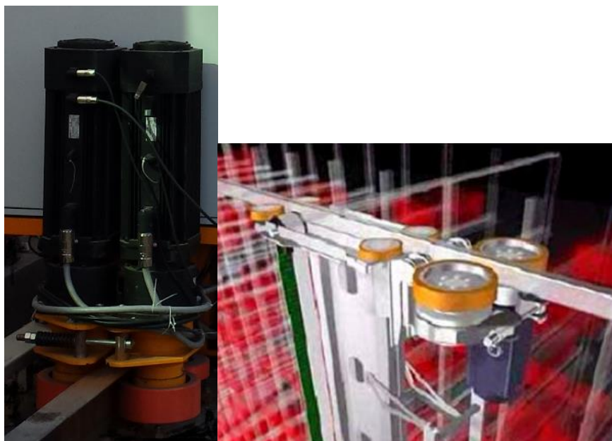
图 2 行走及防摇摆设备结构图
